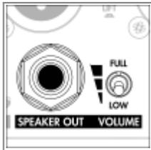
アッテネーターを使用するにはキャビネットをTorpedo Captor XのSPEAKER OUTに接続する必要があります。音量レベルスイッチを使ってアッテネーターを有効化します。
