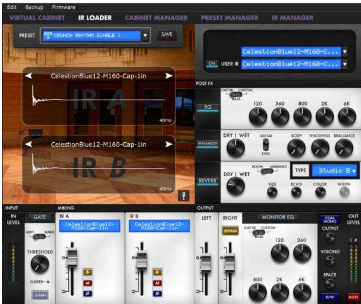
Torpedo Captor Xは最大512個のIRをロードできます。IRのインポートはすべて、Torpedo Remoteを介してIRマネージャー（コンピュータ経由）で行われます。Captor Xにアップロードされると、IRの長さは20ms、40ms、100ms、または200msに設定できます。IRが長い場合、Torpedo Remoteによって選択された長さに短縮されます。短い場合は、選択された長さに合わせて（ゼロで埋められて）拡張されます。内部メモリには、IRの長さに関する以下の制限があります：
