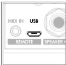
付属のUSBケーブルを使用して、Torpedo Captor Xをコンピュータに接続します。micro USB端をTorpedo Captor Xに接続し、もう一方の端をコンピュータに接続します。
