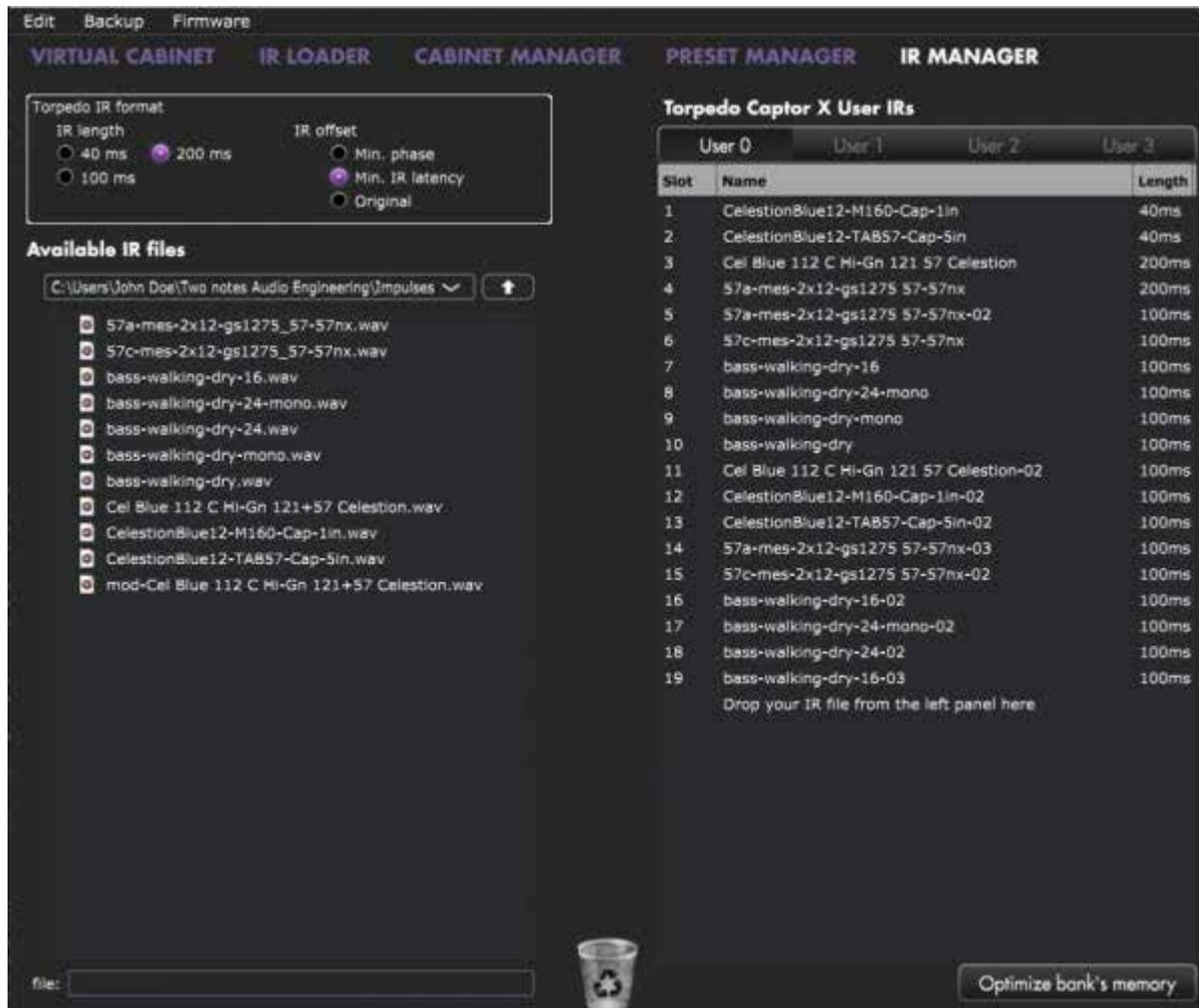
左側のパネルにはコンピュータ上のファイルが表示されます。ここでIRを保存しているフォルダをブラウズできます。右側のパネルにはTorpedo Captor XにロードされているIRファイルが表示されます。IRをコンピュータ(左側)からTorpedo(右側)にドラッグ&ドロップすることができます。ペダルのメモリスロットを空けたい場合は、IRを下部のゴミ箱にドラッグ&ドロップできます。(これはIRをコレクションから削除するのではなく、Torpedo Captor Xから削除するだけです)
