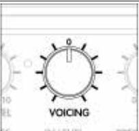
Torpedo Captor Xの前面パネルにあるVOICINGコントロールは、XLR出力から出力されるユニットの全体的な音質を調整するためのものです。900Hzに中心を置いた、-12dBから+12dBの範囲を持つシンプルな1バンドイコライザーです。
