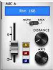
フェーダーを使用して音量レベルを設定し、前後スイッチでマイクをキャビネットの前または後ろに配置します。Bypassボタンで未処理の信号(B)を送信し、Muteボタン(M)でミュートし、Phaseボタン、DistanceおよびAxisノブでマイクの位置を調整します。
